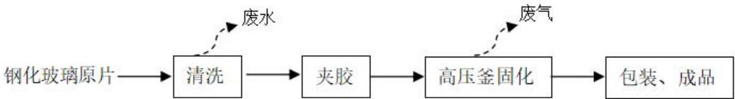
图四：项目双钢夹胶玻璃生产工艺流程及产污环节
