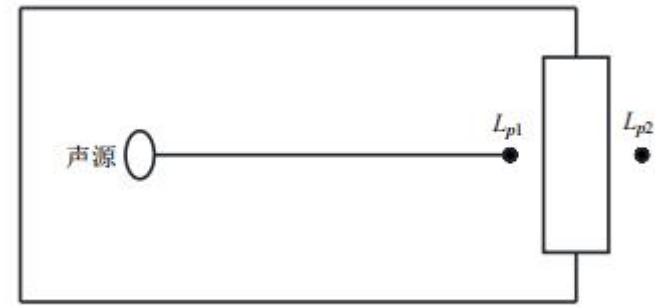
图 4-4 室内声源等效为室外声源图例
