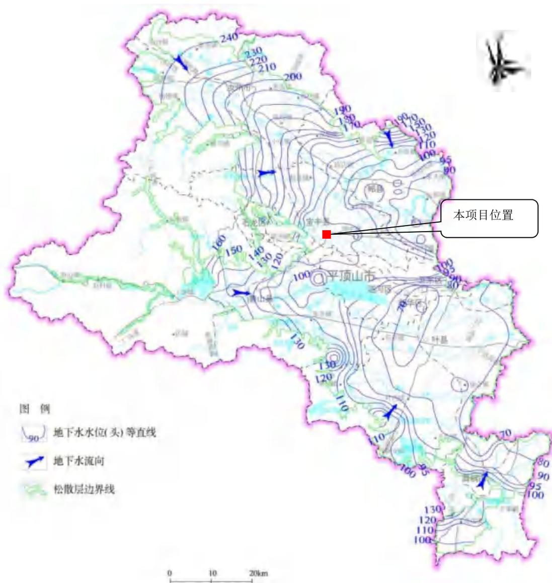
图 4.2.3-6 浅层地下水等水位线图
