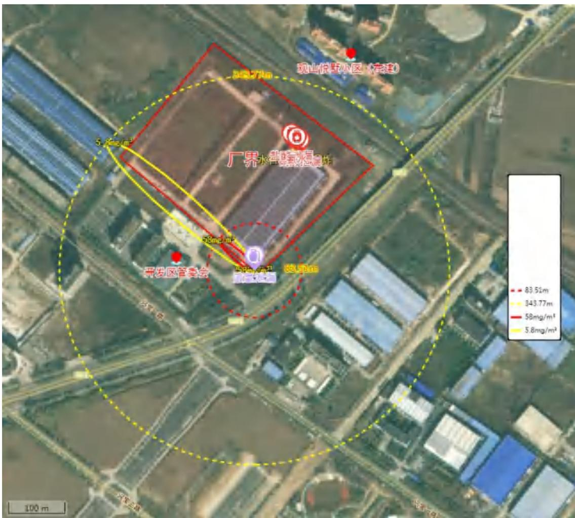
图 4.3.11-20 液氯储罐泄漏最常见气象条件下达到毒性终点浓度最大影响范围图
