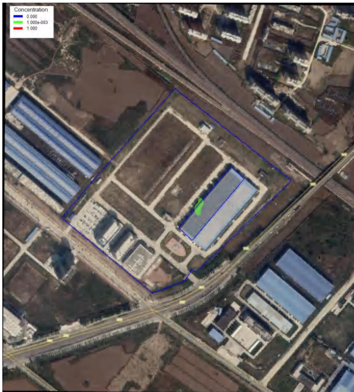
图 4.2.3-39 亚硝酸盐泄漏 100d 时的污染晕图
