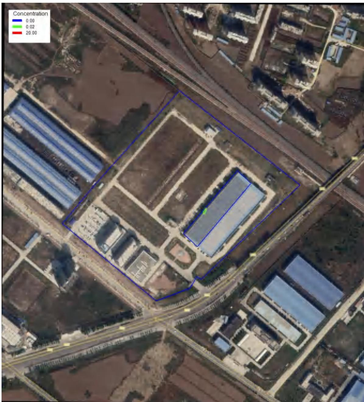
图 4.2.3-35 硝酸盐泄漏 100d 时的污染晕图
