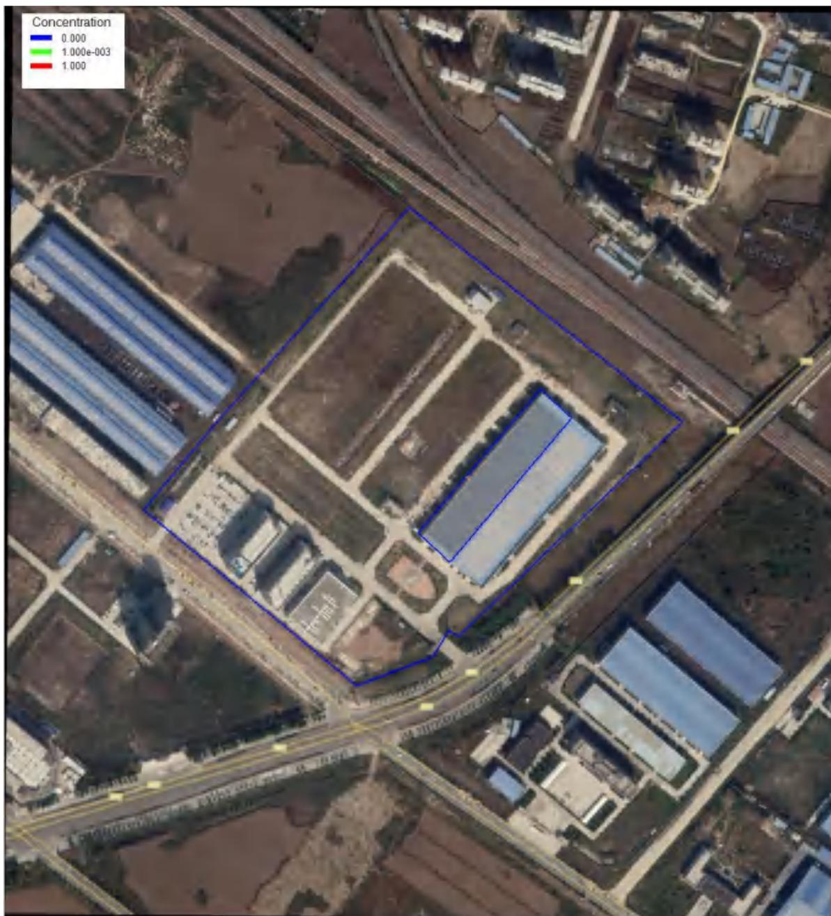
图 4.2.3-41 亚硝酸盐泄漏 3650d 时的污染晕图
