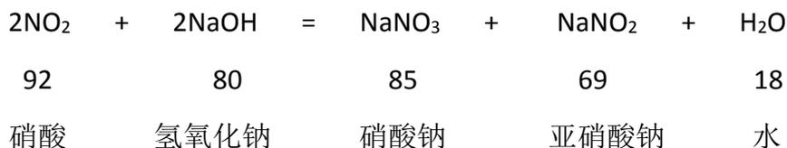
本项目工艺废水污染物产生量较小，且工艺装置仅昼间运行，两级碱液喷淋塔吸收液在线量为 24t/a，吸收液为浓度 10%的氢氧化钠溶液，在碱液喷淋塔运行过程中，每半年更换一次吸收液，在日常运行过程中定时投加氢氧化钠溶液，使其正常运行，保证最佳的运行效果。
