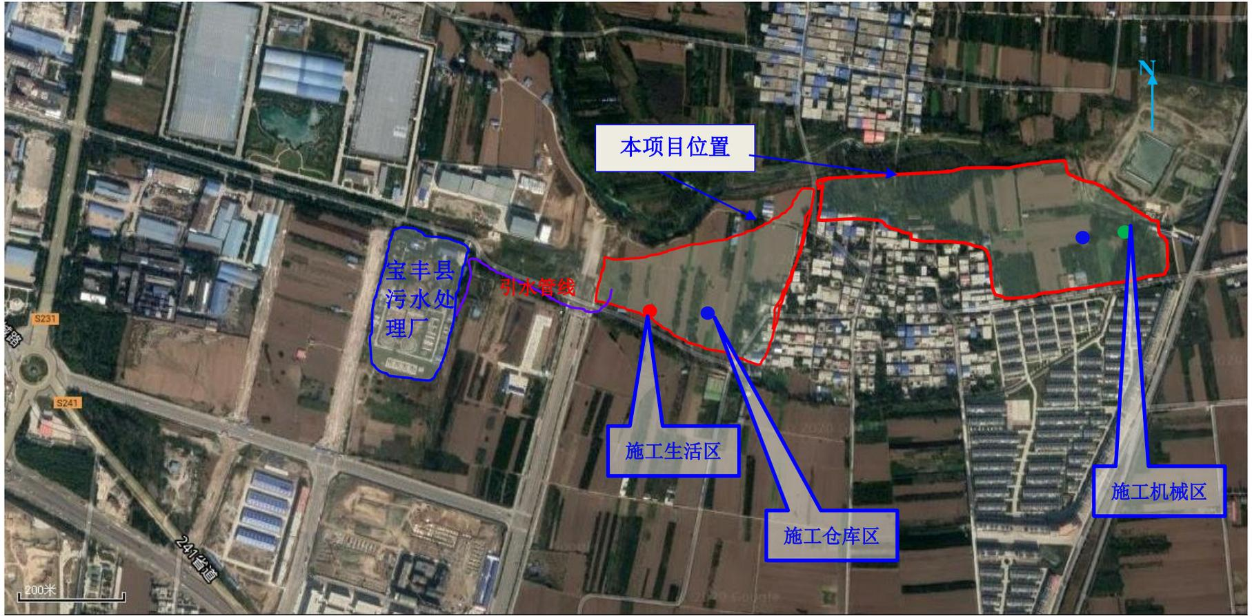
附图五 本项目施工总布置图及施工管线图
