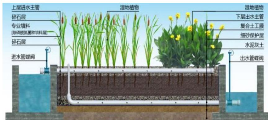
图 2-4 垂直潜流人工湿地示意图
